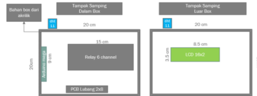
Gambar 2.3 Desain Box Kontrol Tampak Samping
