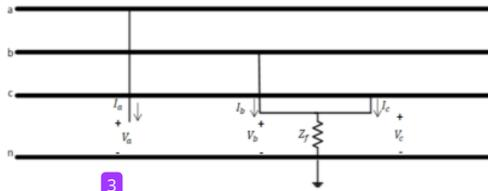
Gambar 1.3 Hubung singkat 2-fasa ke tanah
