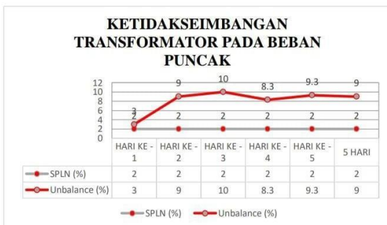
Gambar 4. 7 Grafik Ketidakseimbangan Transformator Pada Beban Puncak
