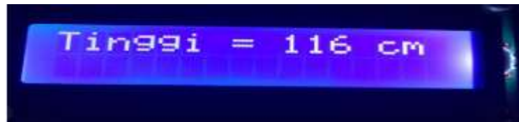
Gambar 4.5 Tampilan hasil dari pengukuran tinggi badan pada LCD kedua
