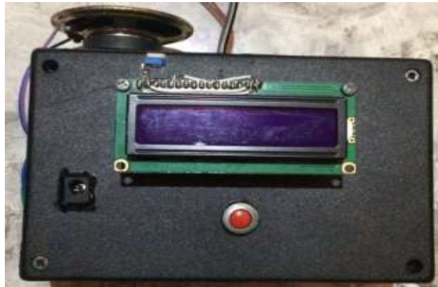
Gambar 4.1 Alat pengukuran tinggi badan otomatis berbasis mikrokontroler
