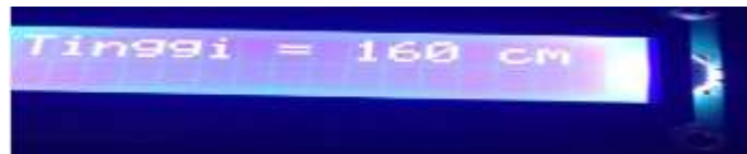
Gambar 4.4 Tampilan hasil dari pengukuran tinggi badan pada LCD pertama
