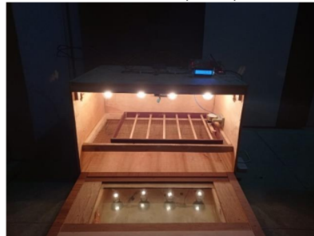
Gambar 7 Inkubator Telur Tampak Depan
