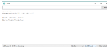
Gambar 10 Tampilan Output saat Tag RFID belum didaftarkan
