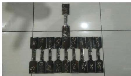
Gambar 4. Material Setelah dipotong menjadi Spesimen Uji tarik
