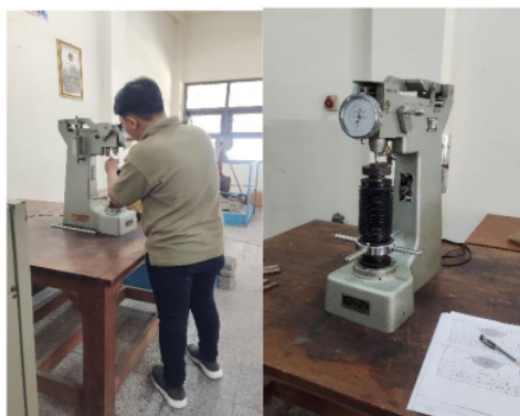
Gambar 8. Proses Uji Kekerasan Struktur Mikro
