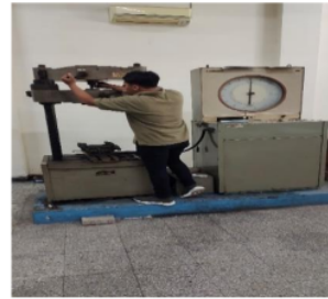
Gambar 7. Proses Pengujian Tarik
