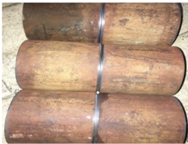
Gambar 2. Material Setelah Pembentukan Kampuh
