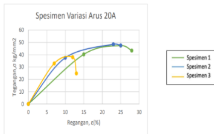
Gambar 11. Grafik Tegangan dan Regangan 20A
