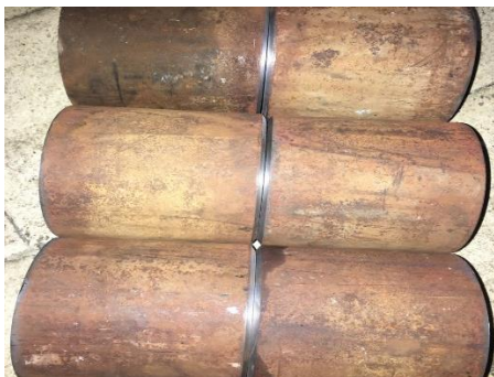
Gambar 2. Material Setelah Pembentukan Kampuh
