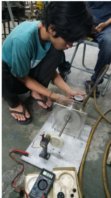
Proses mengukur Rpm, tegangan, dan arus listrik
