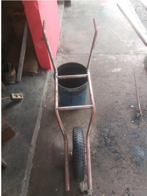
LAMPIRAN 5. Desain Gerobak Artco dengan Ujung Mengkerucut
