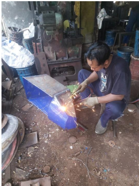
LAMPIRAN 4. Pembuatan Rangka Gerobak Artco
