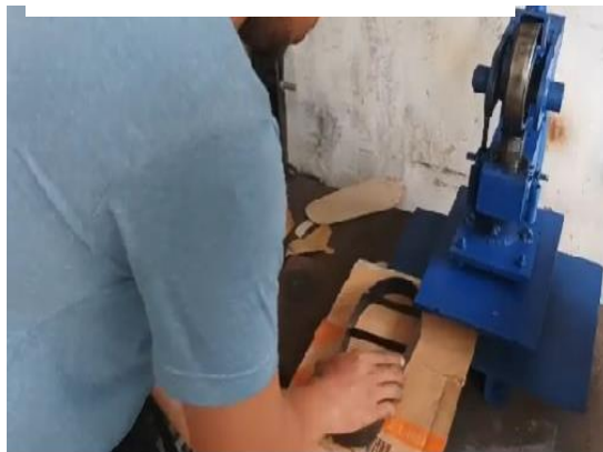
Lampiran 3 Plong Sandal Dengan Mesin PON
