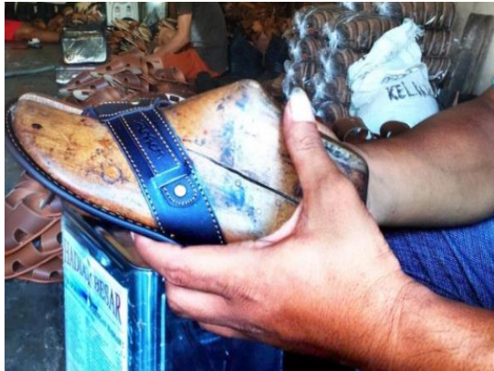
Lampiran 1 Pemasangan Outsole Sandal Pada Klebut
