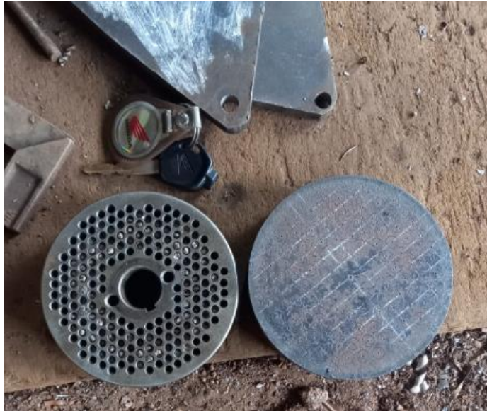
Bahan pembuatan molding (S40C)
