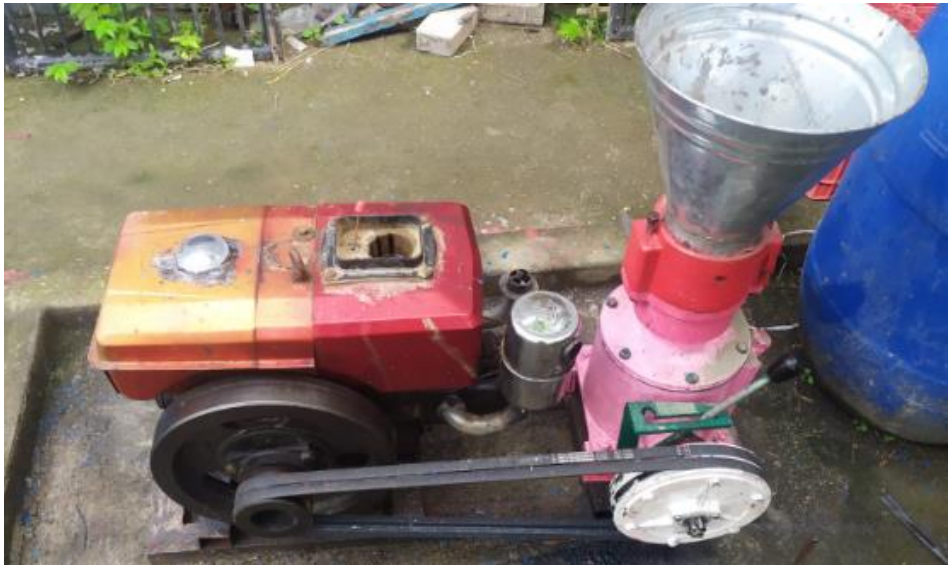
Prototipe alat penekan pada pembuatan briket dengan sistem penggerak motor diesel
