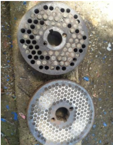
Kondisi molding setelah digunakan
