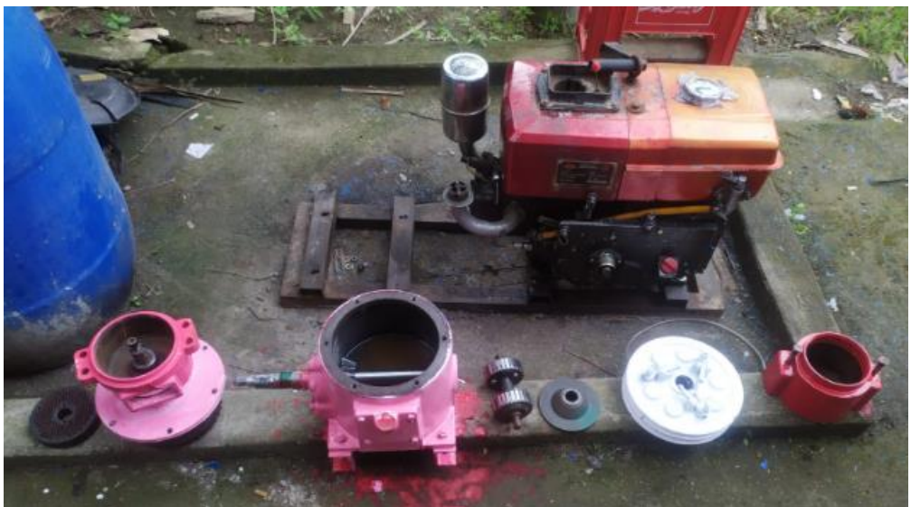
Komponen prototipe alat penekan pada pembuatan briket dengan sistem penggerak motor diesel
