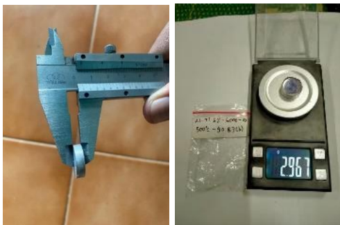
Gambar 4. Proses uji densitas
