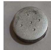
Gambar 10. Hasil spesimen Al-Ti setelah uji keekrasan
