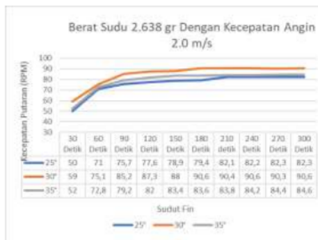
Gambar 3 Hubungan kecepatan turbin terhadap Sudut fin 30° dengan berat 2.638 gr menggunakan kecepatan angin 2.0 m/s.
