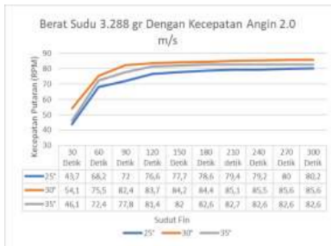
Gambar 5 Hubungan Kecepatan Turbin Terhadap Sudut fin dengan berat sudu 3.288 gr menggunakan kecepatan angin 2.0 m/s.
