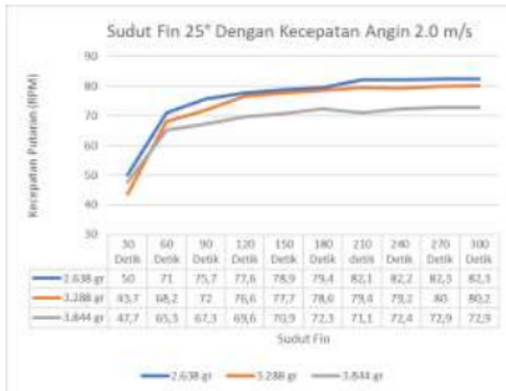
Gambar 9 Hubungan Kecepatan Turbin Terhadap Berat Sudu Dengan Sudut Fin 25° dan kecepatan angin 2.0 m/s.
