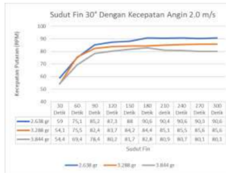
Gambar 11. Hubungan kecepatan turbin terhadap berat 2.638 gr dengan Sudut fin 30° dengan kecepatan angin 2.0 m/s.
