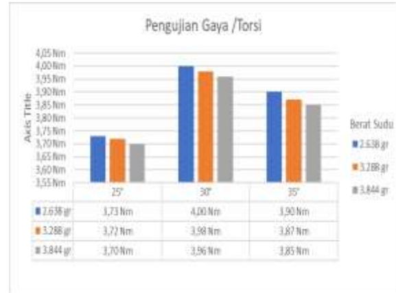
Gambar 14 Hasil pengujian torsi turbin angin dengan kecepatan 2.0 m/s.
