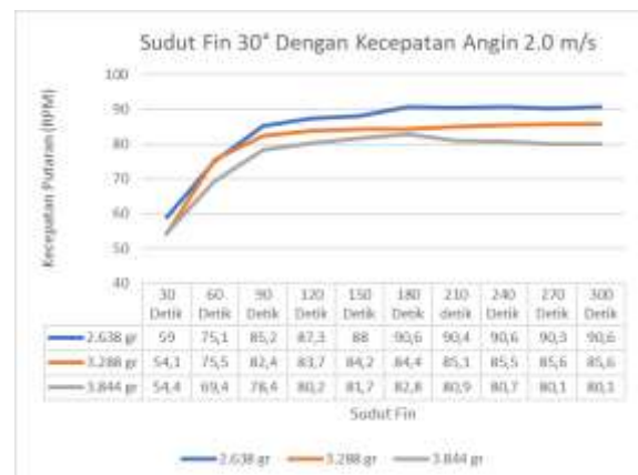
Gambar 11. Hubungan kecepatan turbin terhadap berat 2.638 gr dengan Sudut fin 30° dengan kecepatan angin 2.0 m/s.
