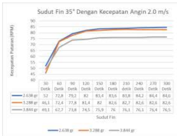
Gambar 13 Hubungan Kecepatan Turbin Terhadap Berat Sudu Dengan Sudut Fin 35° dan kecepatan angin 2.0 m/s.
