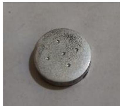
Gambar 3. Hasil spesimen dari pengujian Kekerasan.
