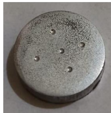
Gambar 2. Material spesimen yang telah diuji Kekerasan Rockwell B
