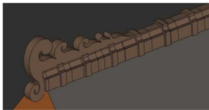
Gambar 12 : Gambar Bubungan Pada Atap Bangunan
