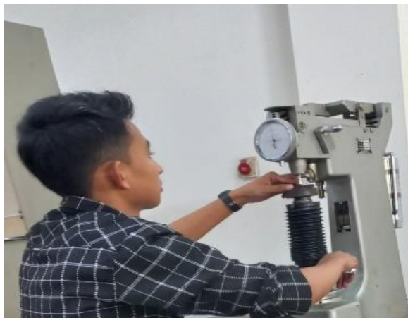
Gambar 10. Proses Pengujian Kekerasan
