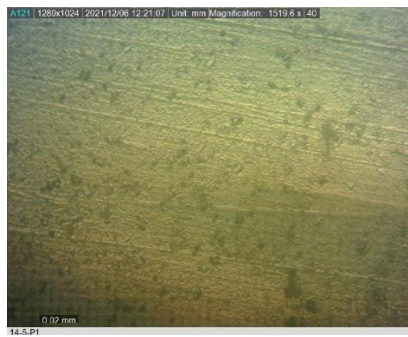
Struktur mikro larutan NaCl 5% Anoda
