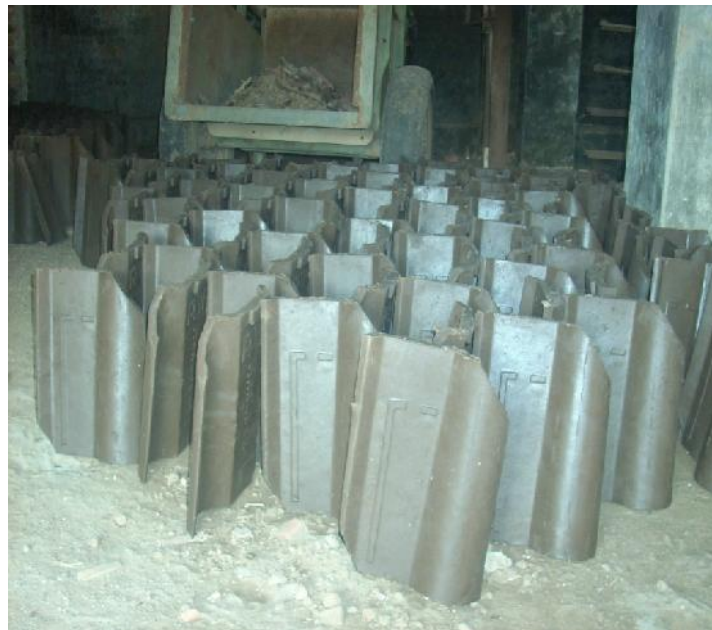
Gambar pengeringan genteng didalam ruangan
