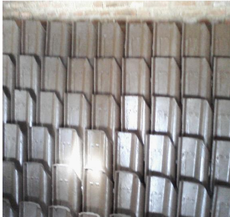
Gambar pengeringan genteng didalam secara bertingkat
