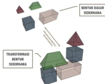
Gambar 9. Ide Bentuk Perancangan SEDERHANA – dalam perancangan kali ini akan mengambil bentuk-bentukan sederhana. Seperti kubus, balok, limas atau bentuk ruang yang sekiranya memiliki tidak lebih dari 5 sisi.
