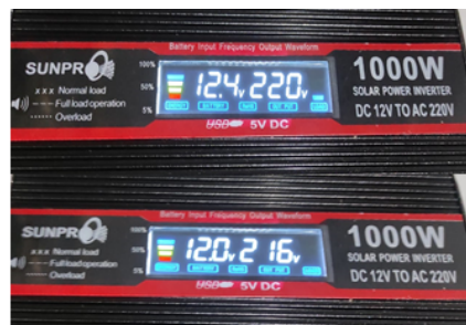
Gambar. 4.3. Perbedaan inverter saat dengan beban dan tanpa beban
