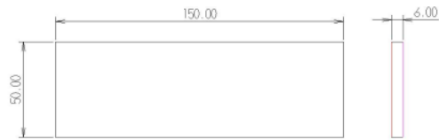
Gambar 2 Dimensi spesimen sebelum dilas
