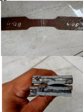
Gambar 20 Hasil Uji Tarik Spesimen Kuat Arus 80 A
