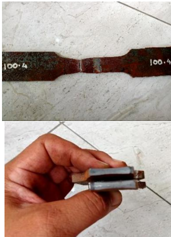
Gambar 22 Hasil Uji Tarik Spesimen Kuat Arus 100 A
