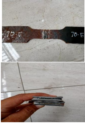
Gambar 19 Hasil Uji Tarik Spesimen Kuat Arus 70 A
