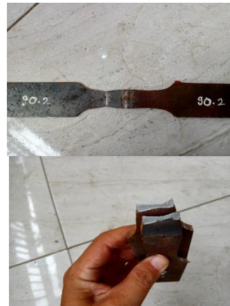
Gambar 21 Hasil Uji Tarik Spesimen Kuat Arus 90 A
