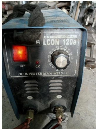
Gambar 2c. Penunjukan kuat arus pada mesin las
