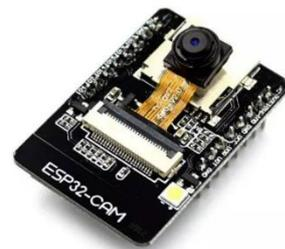
Gambar 2.7 Esp32cam
