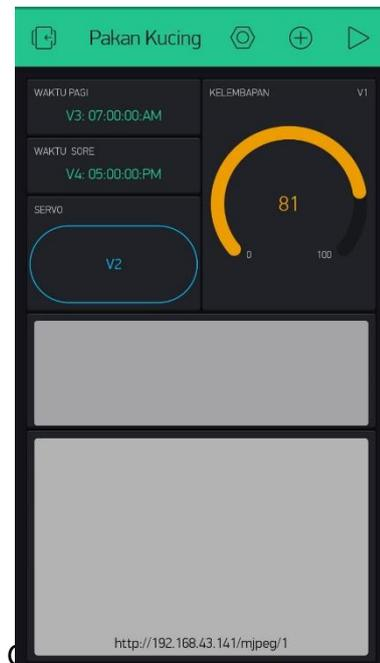
Pada gambar di bawah adalah timer untuk jadwal waktu buka tutup motor servo menggunakan pin V3
