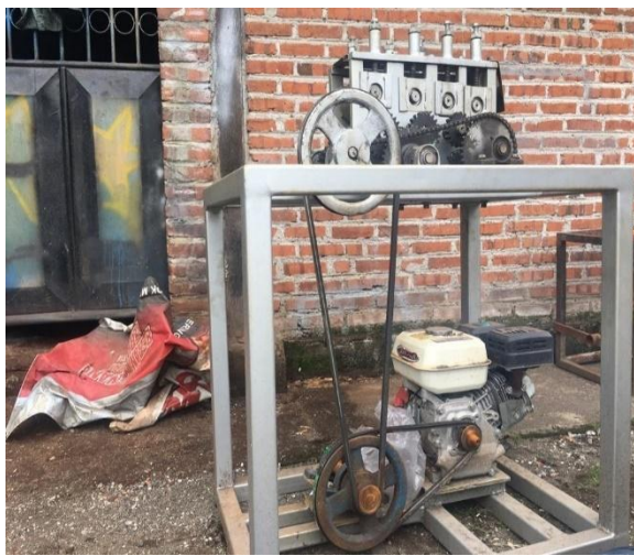
Gambar 4 mesin pemerass tebu
