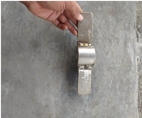
Pembuatan baling – baling pengaduk
