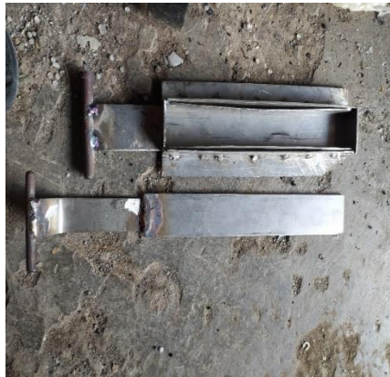
Pembuatan cetakan komposit
