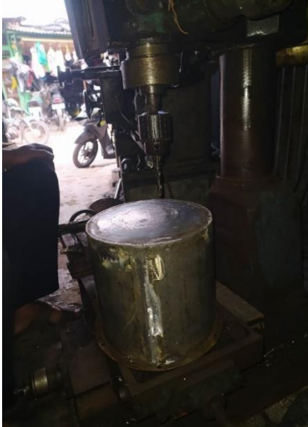
Proses pengeboran saluran keluar cetakan
