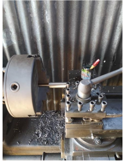
Pembuatan poros dengan mesin bubut
