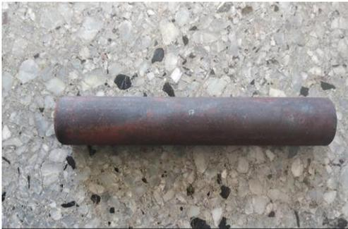
Gambar 4.11 spesimen baja st 37
