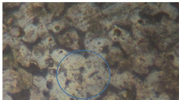
Gambar 4.19 Struktur ferrit
