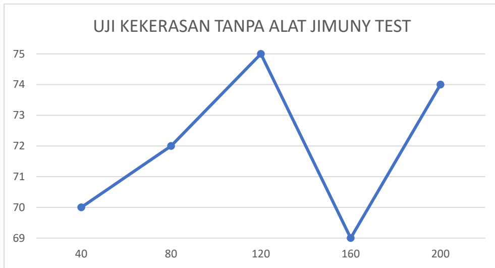
Gambar 4.17 grafik uji kekerasan tanpa pendinginan cepat
