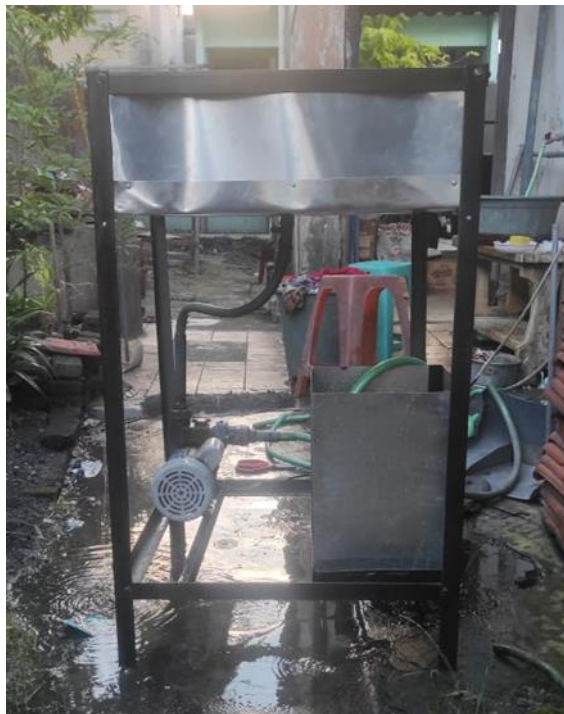
4.1 gambar alat jominy test
