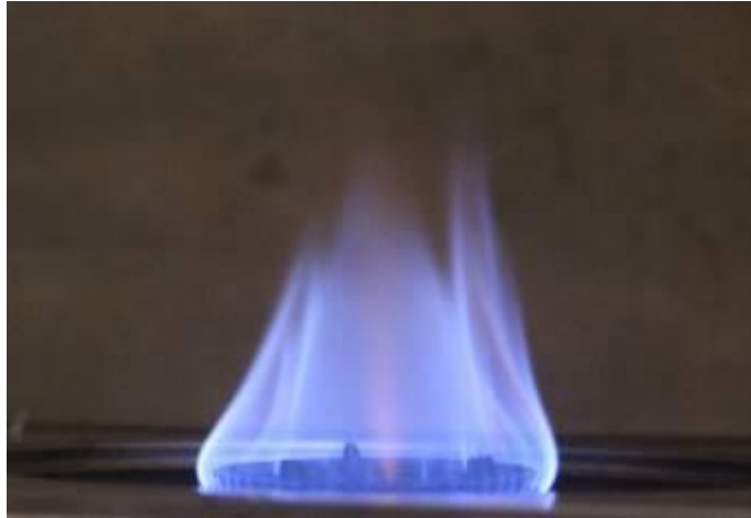
Gambar foto api biogas setelah pemurnian dengan tekanan biogas 30 dan laju aliran 3 lpm.
