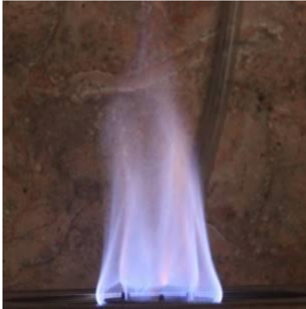
Gambar foto api biogas setelah pemurnian dengan tekanan biogas 30 dan laju aliran 7 lpm.
