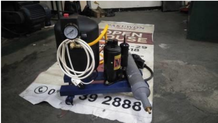
Foto kompresor beserta Filter Pengujian Biogas
