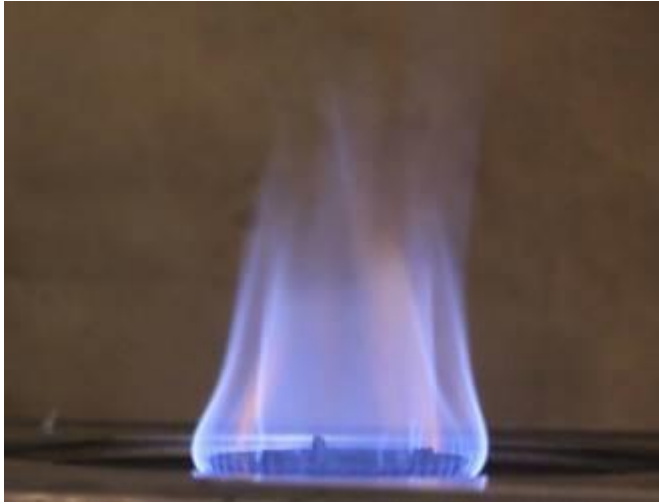
Gambar foto api biogas tanpa pemurnian dengan tekanan biogas 30 dan laju aliran 5 lpm.
