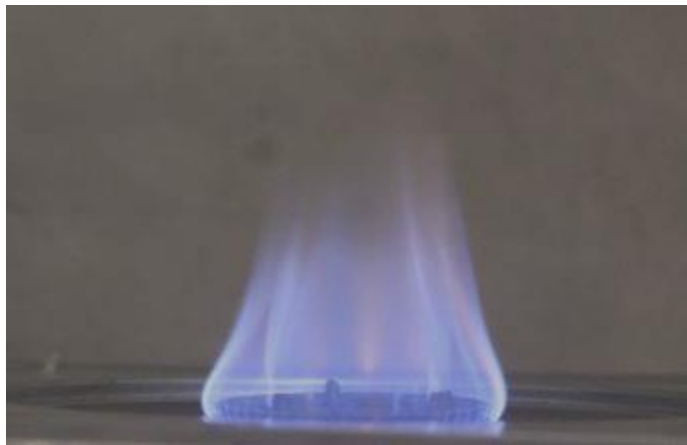
Gambar foto api biogas tanpa pemurnian dengan tekanan biogas 30 dan laju aliran 3 lpm.
