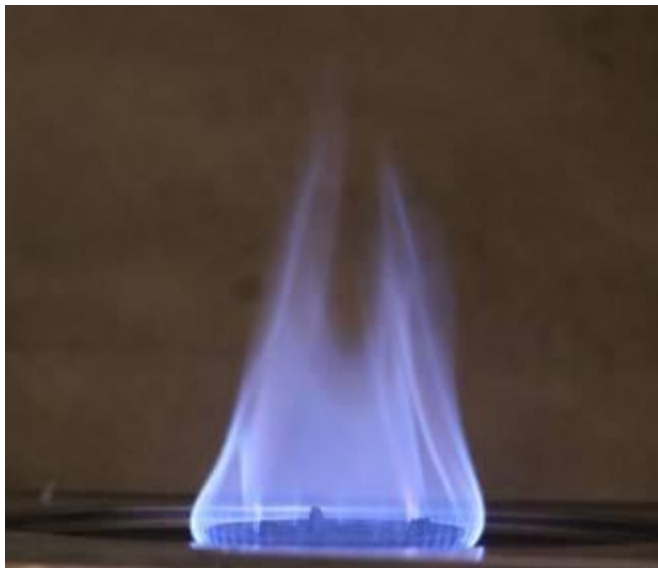
Gambar foto api biogas setelah pemurnian dengan tekanan biogas 30 dan laju aliran 5 lpm.
