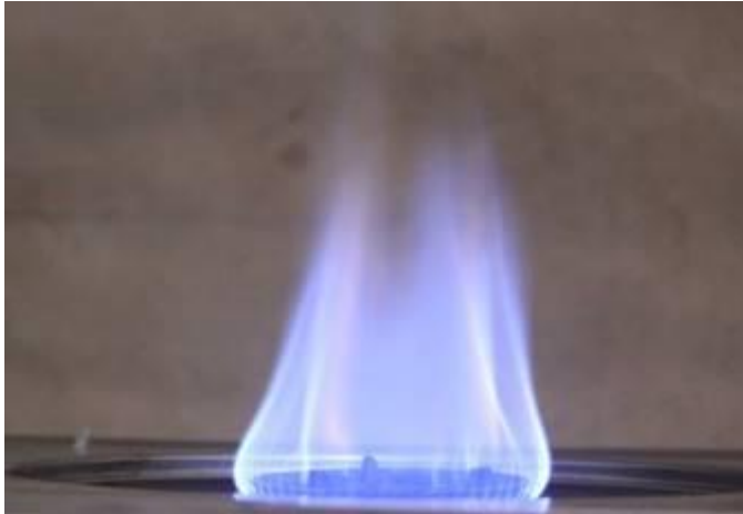
Gambar foto api biogas setelah pemurnian dengan tekanan biogas 20 dan laju aliran 5 lpm.
