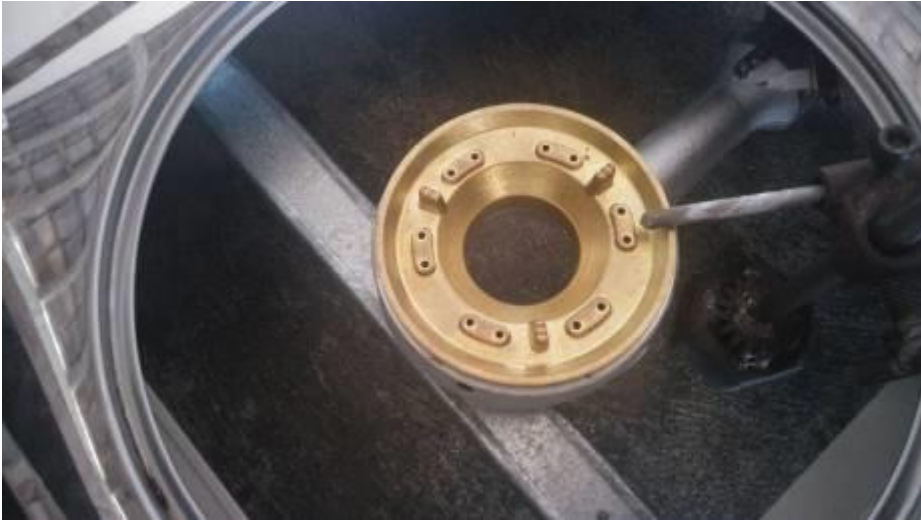
Foto burner kompor biogas
