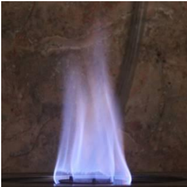
Gambar foto api biogas tanpa pemurnian dengan tekanan biogas 30 dan laju aliran 7 lpm.
