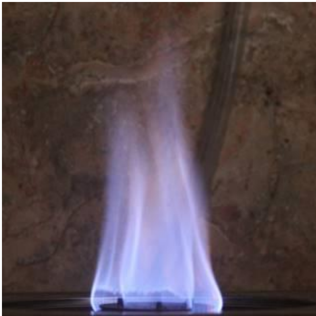
Gambar foto api biogas setelah pemurnian dengan tekanan biogas 20 dan laju aliran 7 lpm.
