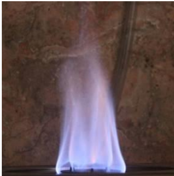
Gambar foto api biogas tanpa pemurnian dengan tekanan biogas 20 dan laju aliran 7 lpm.
