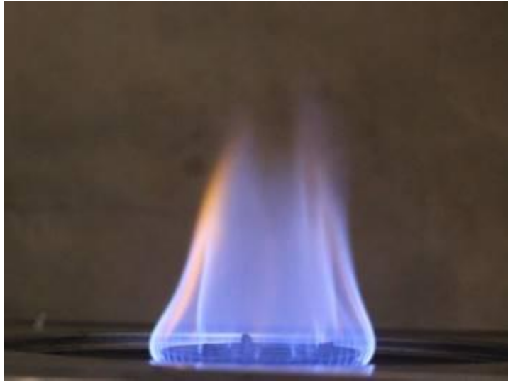
Gambar foto api biogas tanpa pemurnian dengan tekanan biogas 20 dan laju aliran 5 lpm.
