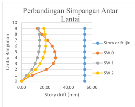
Gambar 7. Grafik perbandingan simpangan antar lantai ( story drift )
