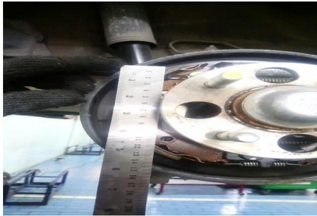
Jarak antara pusat silinder roda dengan pusat engsel sepatu rem 14 cm = 0.14 m
