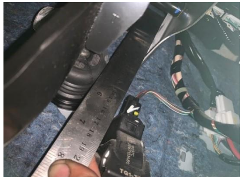
Jarak Pedal Pushroad Ke Tumpuan 12 cm = 0.12 m
