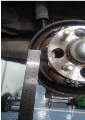
Jarak pusat engsel sepatu rem dengan lebar sepatu rem 7.5 cm = 0.075 m
