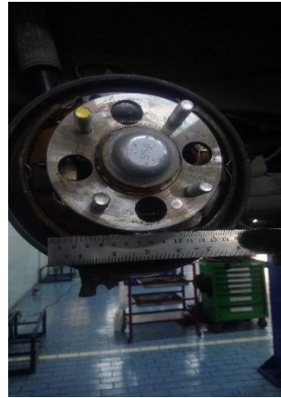
Jarak pusat engsel sepatu rem dengan lebar sepatu rem 6 cm = 0.06 m
