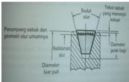
Gambar 2.10 penampang lintang sabuk V dan alur puli
