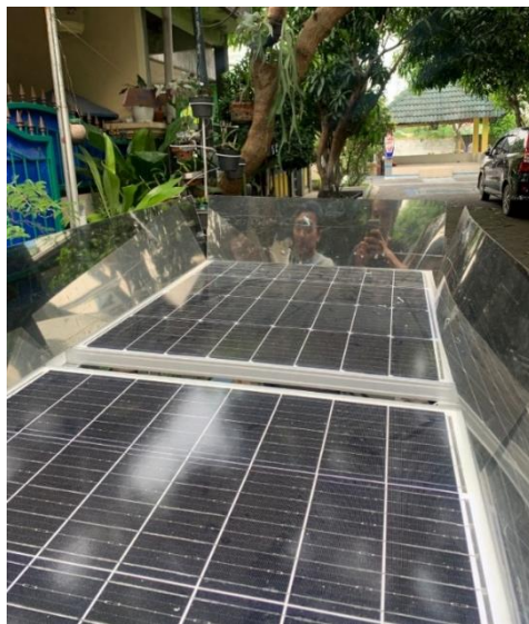
Panel Surya dengan reflektor
