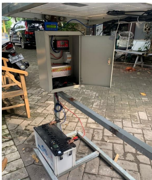
Rangkaian Panel Surya dengan baterai
