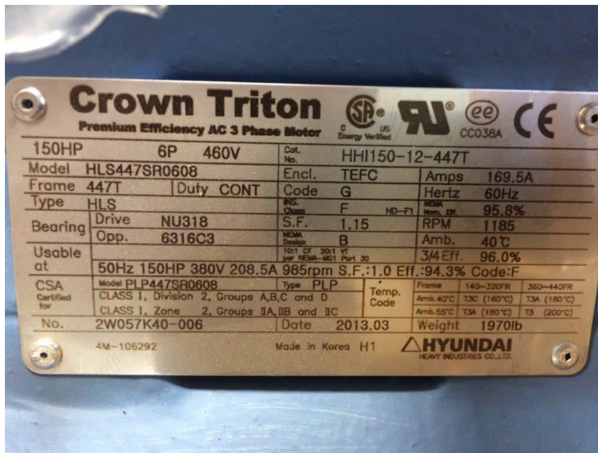
Gambar 3.6 Contoh nameplate motor
