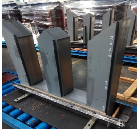
Gambar 2.3 Inti besi pada transformator
