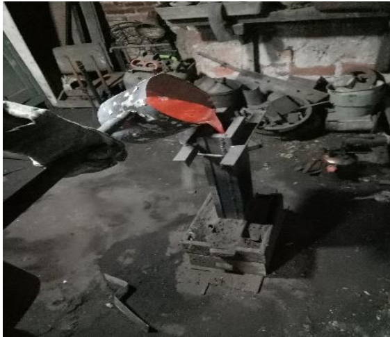
a. Proses Pengecoran metode Gravity Casting
