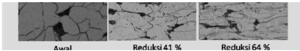
Gambar 2.10 Pengaruh reduksi penampang terhadap strukturmikro
