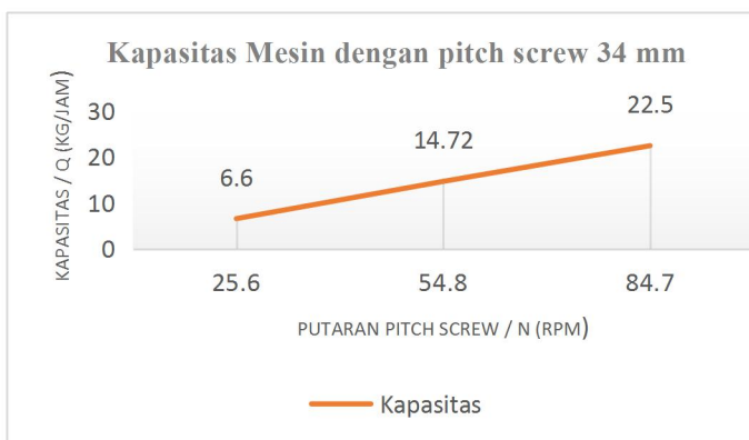
Gambar Grafik Pengujian Pengaruh Putaran Dengan Jarak Pitch Screw 34 mm
