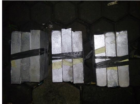
Hasil jadi setelah proses pengecoran
