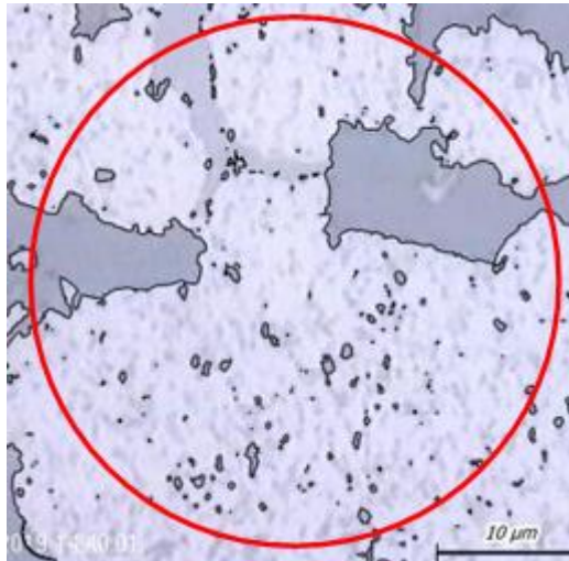
Gambar 8 : A3 ( Temperatur 450 °c laju penarikan 1 mm/detik )
