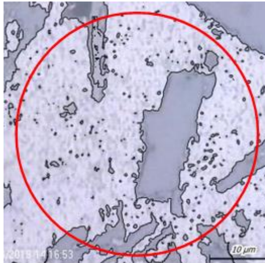
Gambar 7 : C2 ( Temperatur 400 °c laju penarikan 0,01 mm/detik )
