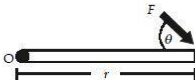
Gambar 6.10 Momen gaya yang ditimbulkan oleh gaya yang membentuk sudut \theta terhadap benda (lengan gaya = r ).
