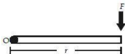
Gambar 6.8 Sebuah batang dikenai gaya sebesar yang tegak lurus terhadap batang dan berjarak sejauh r terhadap titik tumpu O . Batang tersebut memiliki momen gaya \tau = r \times F
