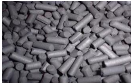
Gambar 1.3. Karbon aktif bentuk pellet
