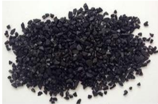
Gambar 1.2. Karbon aktif bentuk granular
