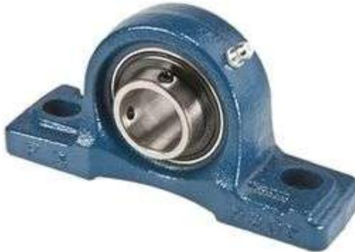
Ini bearing unit paling umum digunakan. Sering disebut laher duduk atau pillow block. Memiliki dua lubang baut yang sumbuinya berlawanan dengan poros bearing. Bisa dipasang duduk normal, terbalik atau menyamping.
