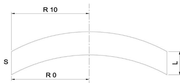
Gambar 16. Luasan selimut kerucut terpancung bidang 0 dan 1 terpancung
