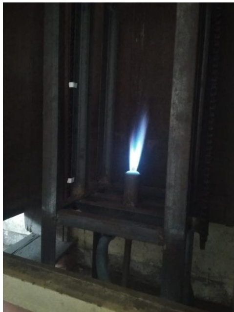
Proses pengambilan bentuk badan api melalui camera
