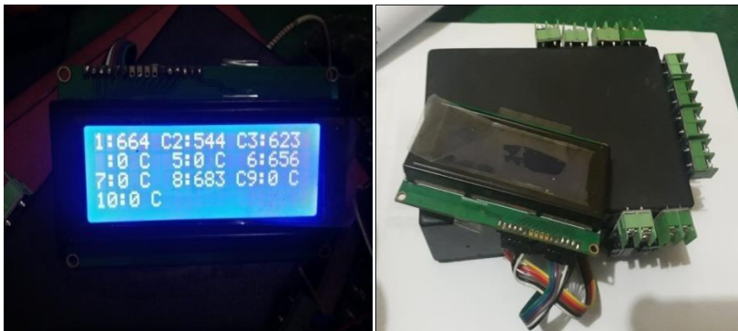
Proses Pembacaan data termokopel di (ardiuono chanel) dan amplifier
