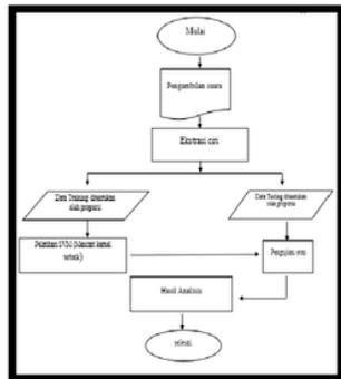
Gambar 2.1 Blok diagram sistem pengenalan suara
