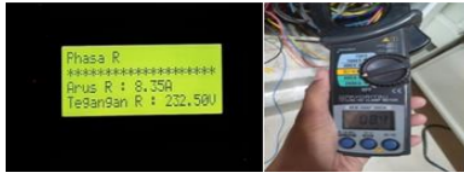
Gambar 6. Pengujian sensor arus pada LCD dan tang ampere
