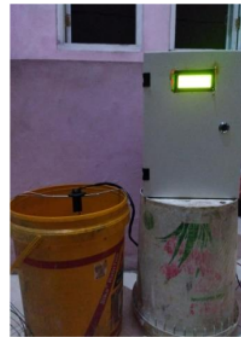
Gambar 14. Uji coba sensor pelampung
